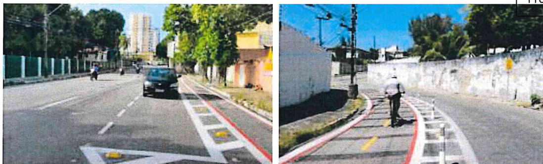
Figura 5.22. Ciclofaixas com buffer de estacionamento e buffer de distanciamento veicular em Fortaleza.
