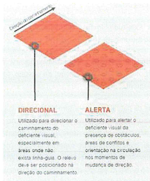
Figura 5.9. Tipologias de piso tátil. FONTE: Cartilha Ilustrativa - Padrões de passeios de Belo Horizonte, 2018.
